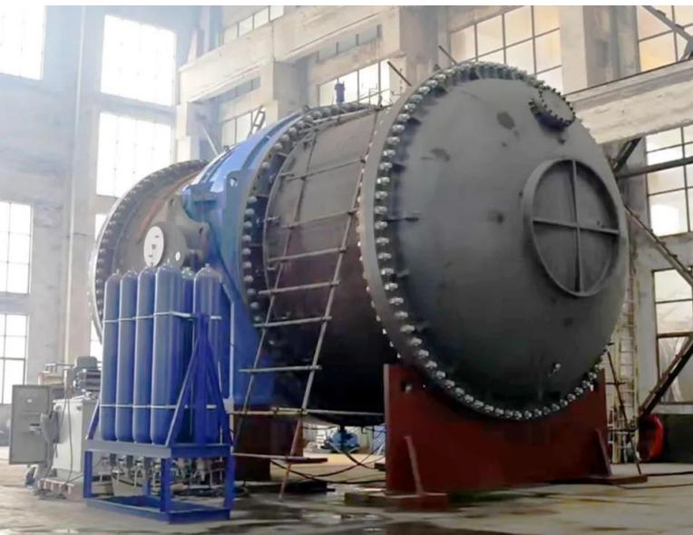
3月20-22日，广东粤海珠三角供水有限公司在中核科技试验厂区，召开首台DN4800液控蝶阀设计制造评定及验收会议。珠三角项目业主和设计院对中核科技的设计方案和阀门性能给予了肯定，与会人员按照试验大纲要求现场见证了壳体强度、蝶板强度、带压开启、主密封正反向密封试、检修阀座动作/密封和液控系统动作等合同要求的全部试验项目。阀门整体模拟现场安装工况，进行联体试验，各项性能满足合同及技术协议要求，其中主密封达到双向零泄漏，检修金属密封性能远优于设计要求，达到国际领先水平。[详情点击](#)
